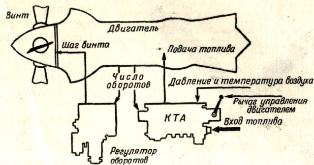
Рис. 9. Схема регулирования турбовинтового двигателя
